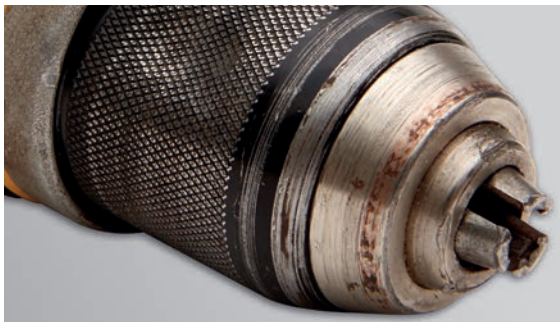
Viallinen istukka – työkalusta ei ole pidetty huolta
