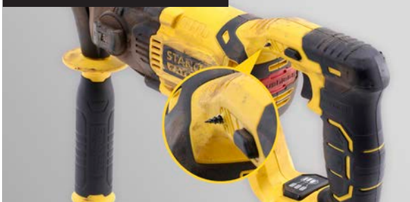
Työkalu on huonosti korjattu
