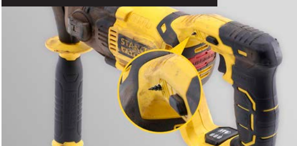
Herramienta incorrectamente reparada
