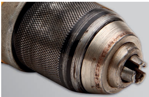
Porta brocas dañado - herramienta no cuidada
