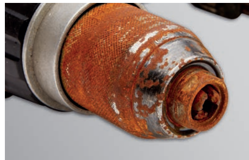
Porta brocas oxidado - dejado a la intemperie
