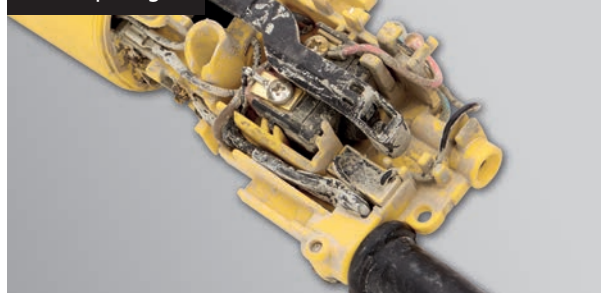
Daños por agua
