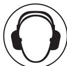
Markējumi uz instrumenta Ausu aizsardzība: aizsargā ausis pret pārmērīgu troksni
