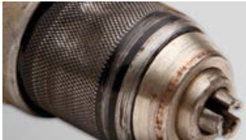
Mandrină deteriorată – unealta nu a fost îngrijită
