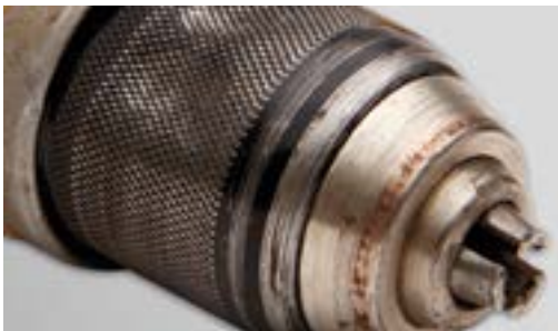
Uszkodzony uchwyt - błędna konserwacja narzędzia
