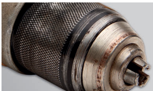
Повреден патронник - за инструмента не е полагана грижа
