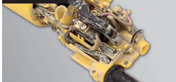
Повреда от вода
