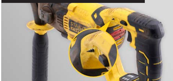
Инструментът неправилно е ремонтиран
